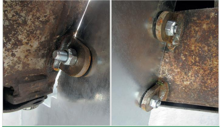
Aufstieg wird mit 3 Schrauben 12 x 30 mit dem Rahmen verschraubt.
