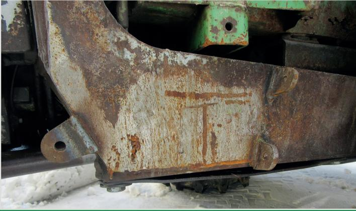
Zum Befestigen des Aufstiegs müssen am Rahmen des Schleppers 3 Schweißösen angeschweißt werden.
