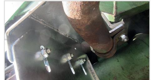
Schutzblech wird mit 3 Schrauben 10x25 mit der Trittplatte verschraubt.
