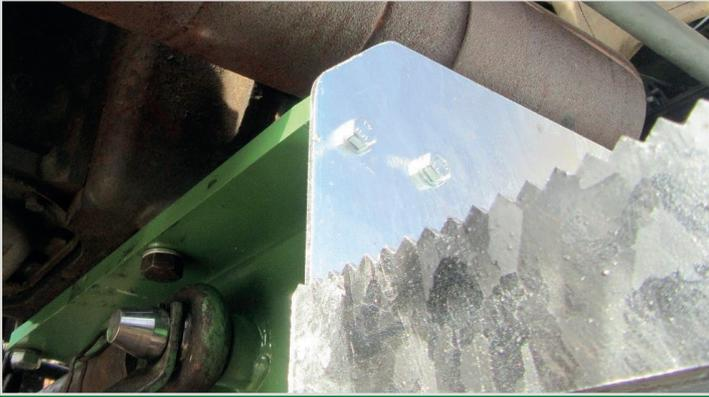
(mit angebautem Seitenmäherwerk) Tritthalter wird mit 2 Schrauben (16x35) und 2x Sprengring am Getriebeblock befestigt.
