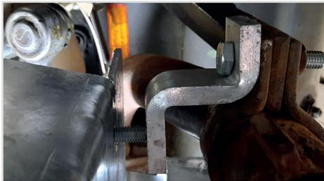
Auspuff wird mit Z-Winkel und jeweils einer Schraube 10x50 und 10x30 mit der Trittplatte verschraubt.
