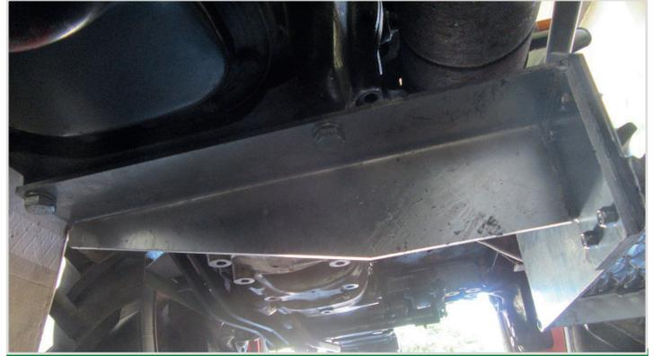
(ohne Seitenmäherwerk) Tritthalter wird mit 2 Schrauben (16x30) und 2x Sprengring am Getriebeblock befestigt.
