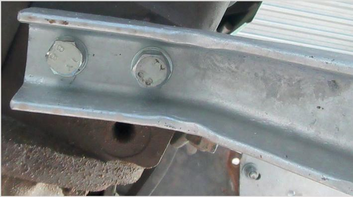
Tritthalter wird mit 2 Schrauben 12 x 25 und Sprengring am Getriebeblock befestigt.
