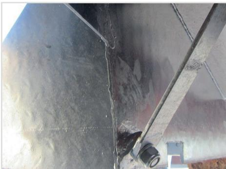
Befestigung der Verstrebung am Auftritt mit Mutter M12.
