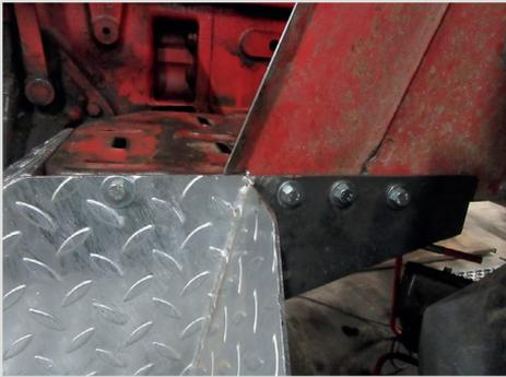
Auftritt wird mit 4 Schrauben 8 x 20 seitlich am Trittbrett befestigt.
