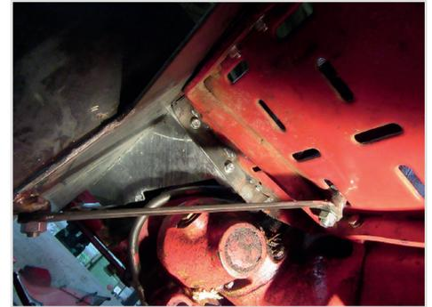
Auftritt wird mit Verstrebung am Trittbrett abgestützt.
