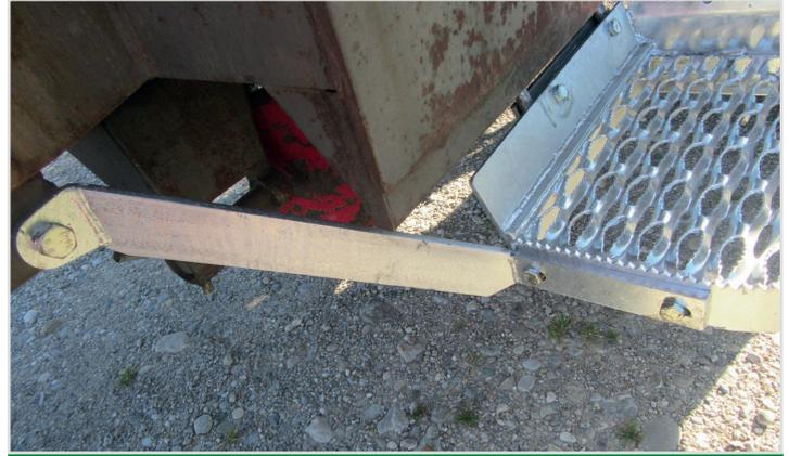
Verstrebung wird mit Sechskantschraube 14 x 30 am Schlepper und 2 Sechskantschrauben 10 x 25 am Auftritt verschraubt.
